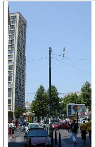
Photo 3 : Mesure de la température à la surface d'une rue de Marseille
